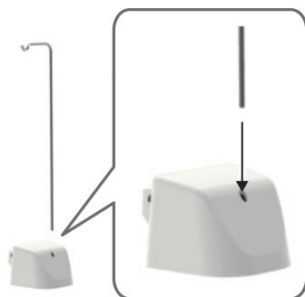
2. Inserire il supporto di irrigazione nel foro sul retro del coperchio della pompa.
