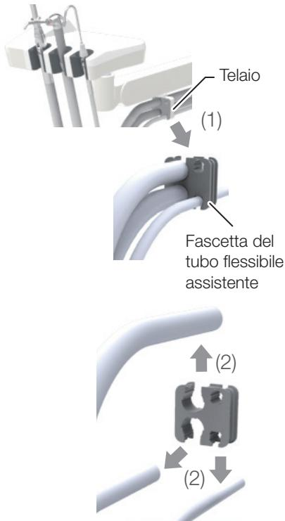
La fascetta del tubo flessibile assistente dell'unità assistente è amovibile dal telaio, il che è adatto per la pulizia.
