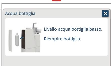
Quando il livello della bottiglia dell'acqua scende al di sotto del livello specificato, questa indicazione viene visualizzata dopo una schermata popup di avvertenza. Quando viene visualizzato il popup, sostituire immediatamente la bottiglia dell'acqua con una nuova.
