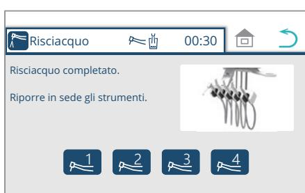
7. Una volta terminato il risciacquo, riportare il manipolo nel portastrumenti. Quando il manipolo viene riportato indietro, viene visualizzata la schermata iniziale.
