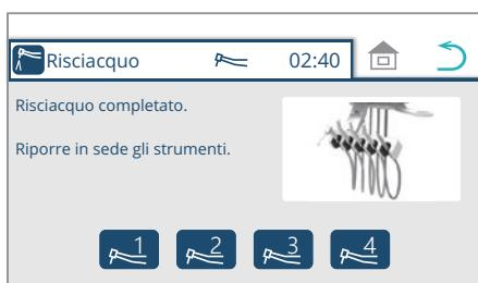
6. Una volta terminato il risciacquo, riportare il manipolo nel portastrumenti. Quando il manipolo viene riportato indietro, viene visualizzata la schermata iniziale.
