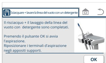
3. Al termine del risciacquo della linea di aspirazione + lavaaggio della linea di aspirazione con detergente, premere l'interruttore .
