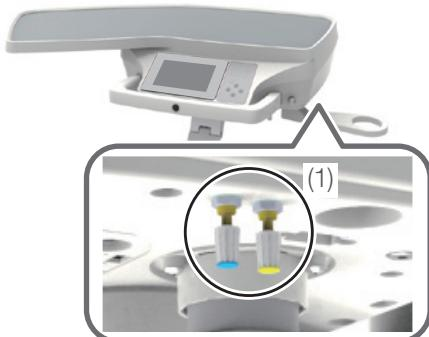
**Regolazione della quantità di acqua/aria fornita allo spruzzo della siringa**
