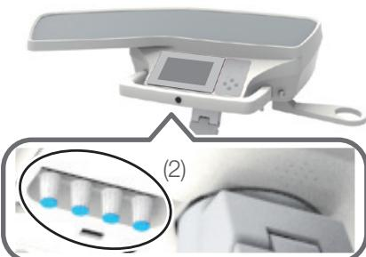
**Regolazione della quantità di acqua fornita allo spruzzo del manipolo**
