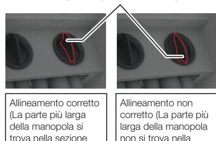
Premere il raccoglitore di solidi nell'estremità del contenitore con il corretto allineamento. Se non è montato correttamente, il manipolo di aspirazione e il manipolo aspirasaliva potrebbero non funzionare correttamente.
