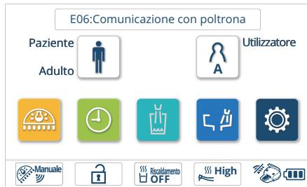
Quando si spegne la poltrona, "E06: comunicazione con poltrona" viene visualizzato sul pannello a sfioramento a causa dell'interruzione della comunicazione tra l'unità e la poltrona, quindi l'indicatore LED dell'unità della sputacchiera si illumina in arancione, il che non indica un malfunzionamento.
