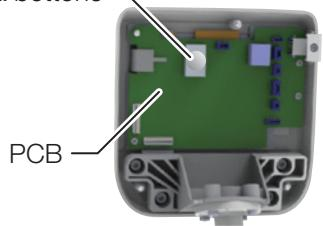
2. Staccare la batteria a bottone (CR1632) sul PCB.
