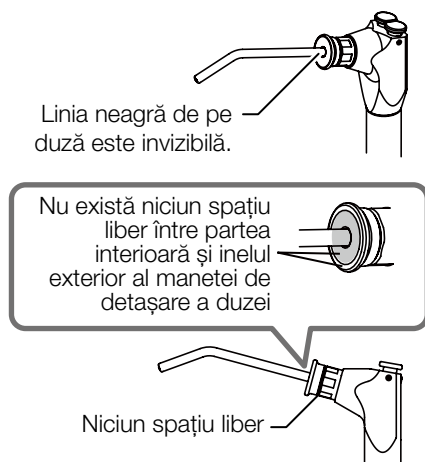
Exemplu de atașare a duzei Exemplu bun
