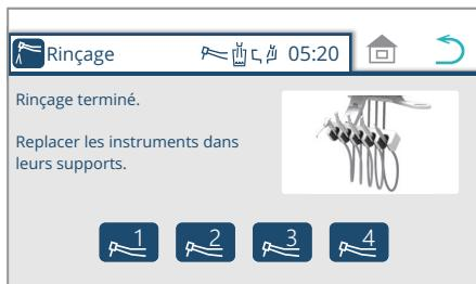
7. Une fois le rinçage de la ligne d'aspiration terminé, replacez les pièces à main de l'unité médicale sur le support de l'instrument.
