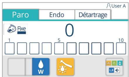
Lors de l'utilisation de la puce autre que la spécification d'arrêt de l'alimentation en eau, utilisez le détartrageur avec l'alimentation en eau activée (écoulement de l'eau).
