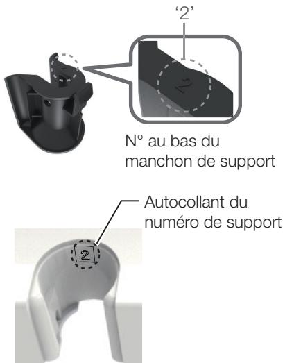
Chaque manchon de support porte un numéro en bas et un autocollant indiquant le même numéro est apposé sur le support d'assistant. Veillez à fixer le manchon du support sur le support ayant le même numéro.
