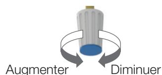
Tous les boutons diminuent le débit lorsqu'ils sont tournés dans le sens des aiguilles d'une montre et l'augmentent lorsqu'ils sont tournés dans le sens inverse des aiguilles d'une montre.
