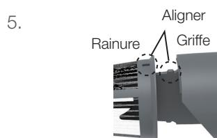
5. Alignez la griffe sur le capuchon du collecteur de solides avec la rainure du filtre pour les fixer.
