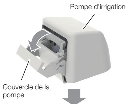
6. Ouvrir le couvercle de la pompe. Fixer la cassette de la ligne d'irrigation à la pompe d'irrigation.
