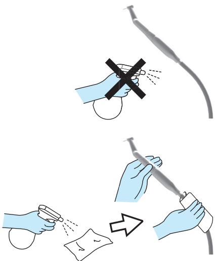
Ne pulvérisez pas de détergent directement sur l'extérieur de l'appareil.
