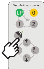
1. Déplacez l'assise du fauteuil et le dossier dans la position souhaitée à l'aide de l'interrupteur de commande manuelle ou de l'interrupteur de préréglage situé sur le panneau de commande.
