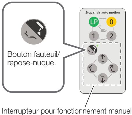
Interrupteur pour fonctionnement manuel
