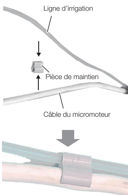
9. À l'aide du dispositif de retenue, fixer la ligne d'irrigation sur le câble du micromoteur.
