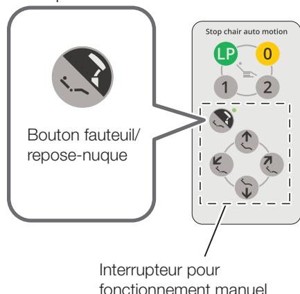
Pour l'actionner avec le bouton de fonctionnement manuel, appuyez sur le bouton fauteuil/repose-nuque pour sélectionner la fonction repose-nuque (le témoin est allumé).
