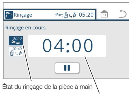
Si la vasque du crachoir n'est pas présente, le rinçage de la ligne d'aspiration démarre 5 minutes après le rinçage des circuits d'eau des pièces à main.
