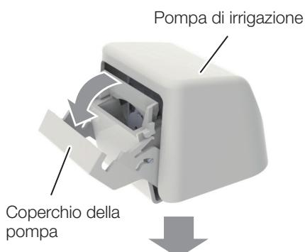
6. Aprire il coperchio della pompa. Collegare la cassetta della linea di irrigazione alla pompa di irrigazione.
