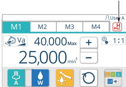
Se il prodotto viene utilizzato per un lungo periodo con un carico elevato, la funzione di prevenzione surriscaldamento viene attivata e la coppia viene automaticamente diminuita per evitare il surriscaldamento dell'unità micromotore. In questo caso, viene emesso un segnale acustico e viene visualizzato **H**. Mentre viene visualizzata questa indicazione, la funzione di prevenzione surriscaldamento è attivata.
