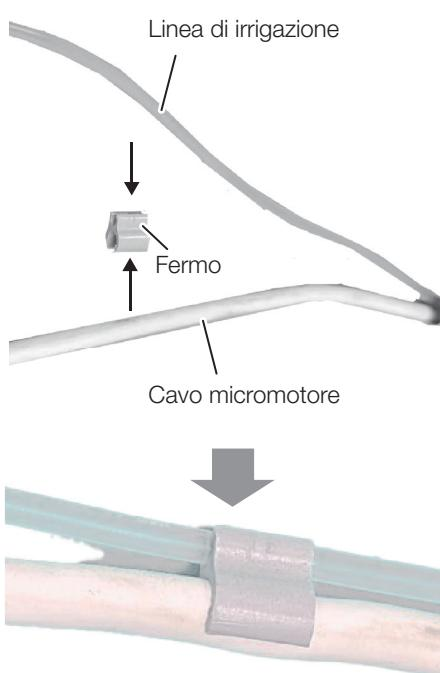
9. Con il fermo, fissare la linea di irrigazione sul cavo del micromotore.
