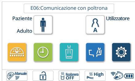
Quando si spegne la poltrona, “E06: comunicazione con poltrona” viene visualizzato sul pannello a sfioramento a causa dell'interruzione della comunicazione tra l'unità e la poltrona, quindi l'indicatore LED dell'unità sputacchiera si illumina in arancione, il che non indica un malfunzionamento.
