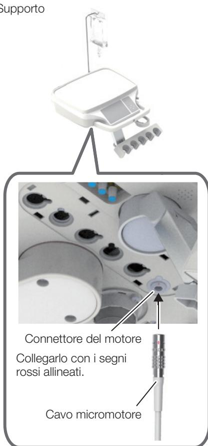
1. Collegare il cavo del micromotore MX-i LED 3a Gen. al connettore del motore.
