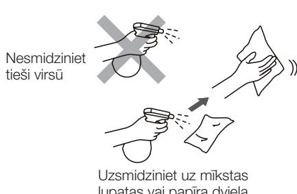
Kad galvenā vadības paneļa virsma ir notīrīta ar dezinfekcijas līdzekli u.tml., pilnībā noslaukiet dezinfekcijas līdzekli.
