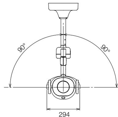
\*Wählen Sie die Länge des Hängerohrs auf der Grundlage der Deckenhöhe aus.
