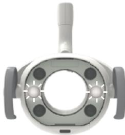
Dieses Produkt ist mit einem berührungslosen Schalter ausgestattet, mit dem die Benutzer das Licht ein- und ausschalten und zwischen den Betriebsmodi umschalten können, ohne das Produkt zu berühren. Der berührungslose Schalter innerhalb der Sensorabdeckung (kann manuell betrieben werden maximal ca. 65 mm von der Oberfläche des Sensorfensters entfernt und innerhalb der Breite des Sensorfensters).
