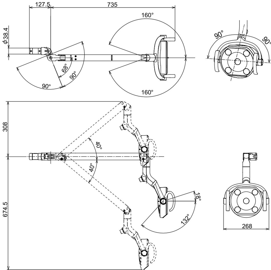
Produktcode: Gerätetyp tbCompass (Typ 320PAS)\* (genau wie beim AL-320S außer nachfolgender Abbildung)
