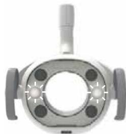
Ce produit est équipé d'un interrupteur sans contact, ce qui permet aux utilisateurs d'allumer et éteindre la lampe et changer de mode sans contact avec le produit. L'interrupteur sans contact peut fonctionner manuellement à l'intérieur de la plage du capteur (à environ 65 mm de distance de la surface de la fenêtre du capteur et à l'intérieur de la largeur de la fenêtre du capteur).
