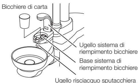
Posizionare il bicchiere (contenitore carta) sulla base del sistema di riempimento bicchiere, l'acqua fuoriesce dall'ugello del sistema, riempie il bicchiere e si arresta automaticamente. Quando si avvia il sistema di riempimento bicchiere, anche il sistema di risciacquo della sputacchiera di avvia per circa 6 secondi per poi arrestarsi automaticamente.
