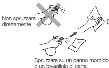
Quando la superficie del pannello di controllo principale viene pulita con un disinfettante, ecc., rimuovere completamente il disinfettante. Se penetra nella parte posteriore del foglio, gli interruttori a membrana potrebbero non funzionare correttamente.
